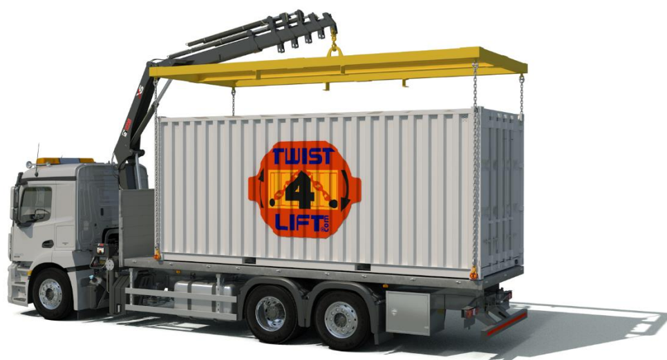
Figuur 2. Hijsen van een container m.b.v. een evenaar (boven) of viersprong (onder) en Twist4lift containerhaken in de corner castings.
